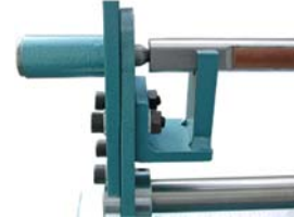
Fix shaft with knife protection Fixe Welle mit Messerschutz
