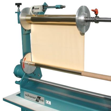
RG machine with option winding unit and linear measure unit RG Maschine mit Option Umwickelvorrichtung und Längenmessenheit
